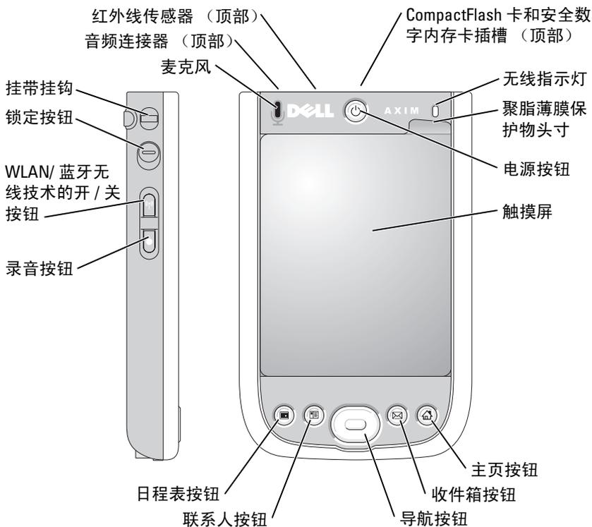
**红外线传感器** — 不使用任何电缆连接将文件从您的设备传输至另一个红外线兼容设备。
