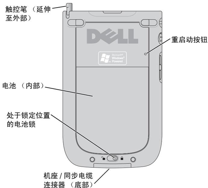
**电池锁** — 使用此开关可以松开并取出主电池。请参阅第 40 页的“安装和取出电池”。
