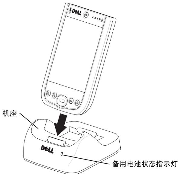
将设备对接入机座后，设备上的电源按钮将打开，命令栏中将显示连接状态图标（请参阅第 54 页）。
